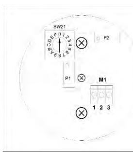
**SW21**: Drehbares switchzur regulierung vom ausgangssignal
