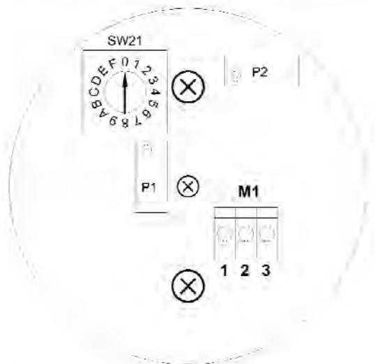
**SW21** : Switch rotativa regulación amplificación
