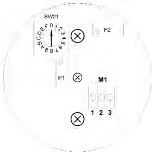
**SW21** : Switch rotative de régulation amplification signal sortie
