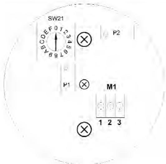
**SW21** : Switch rotativo regolazione amplificazione del segnale di uscita
